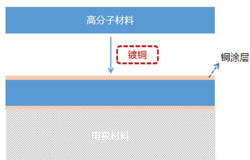
图 7: 复合铜箔结构
