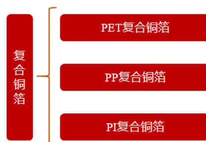
图 8: 三种使用不同基膜材料的复合铜箔
