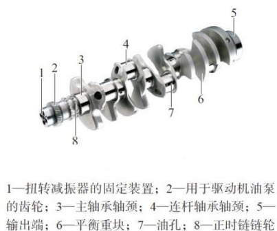
图 7：曲轴结构图
