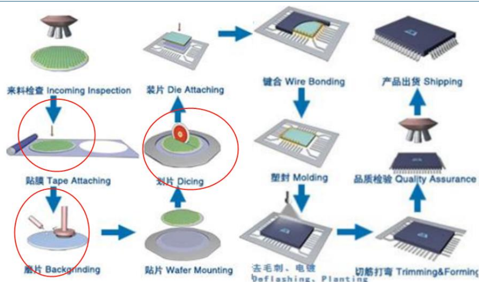
图表34：晶圆封装环节工艺流程图（三磨所产品集中在贴膜、研磨、划片等环节）
