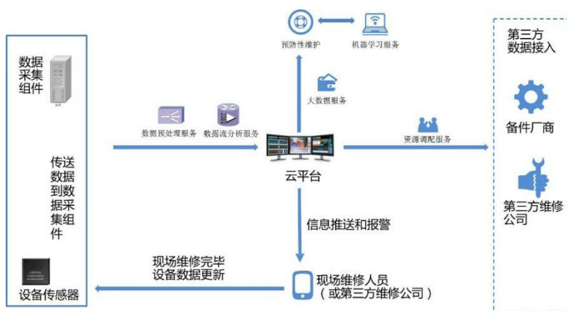
图 40：第三方光伏运维系统架构图
