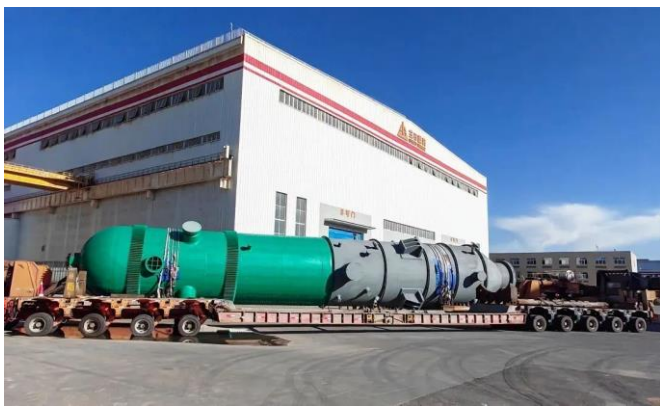
图表 119. 中海油惠州石化煤气化制氢项目气化炉
