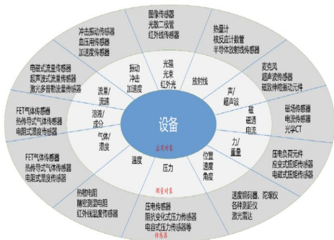
图表30：按测量对象分类的传感器
