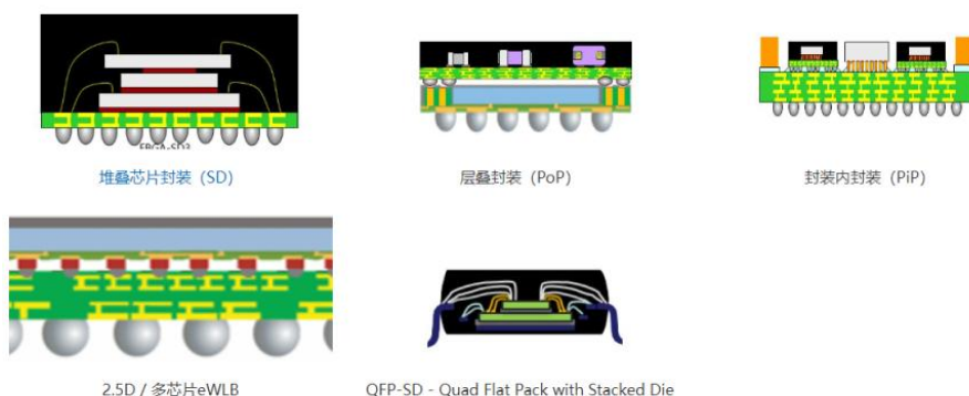
图25：长电科技 2. 5/3D 封装
