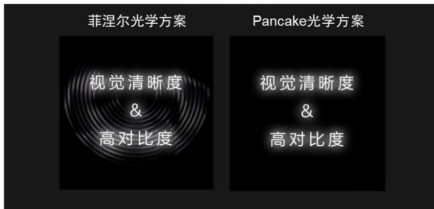
图75: 菲涅尔光学方案和 Pancake 光学方案的成像效果对比
