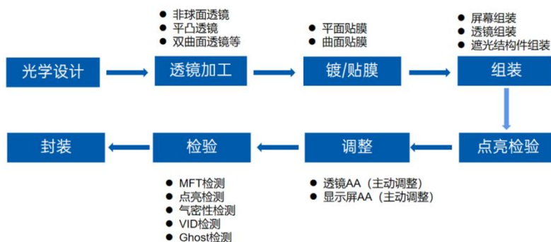
图 73: Pancake 光学模组加工流程
