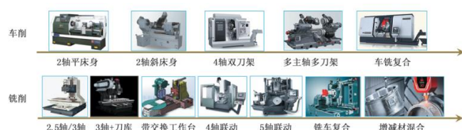
图19：机床主机结构的演进
