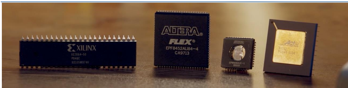
图2：FPGA 实物图（从左到右依次为 Xilinx、Altera、Altera、Actel 的 FPGA/CPLD 芯片）
