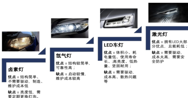
图11：汽车车灯不断升级：卤素灯-氙气灯-LED 灯-激光灯
