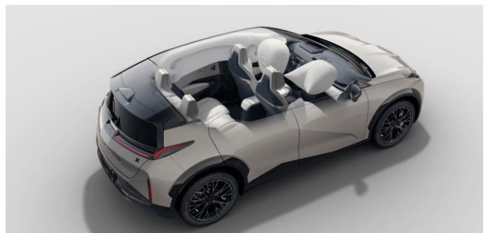
图 67：副驾的 FOX 环抱式气囊和侧面的延展式气帘，给予全方位安全气囊防护
