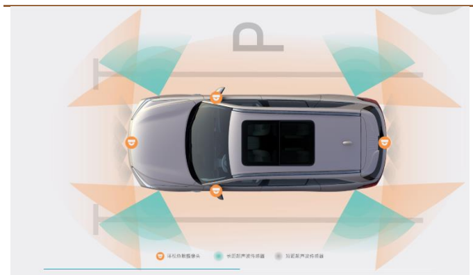
图 26：蓝山全车配备 26 个硬件传感器
