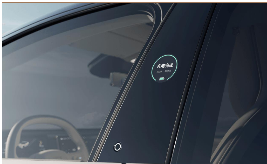
图 60：极氪 X 搭载的智能 B 柱交互系统，能实时显示汽车充电情况
