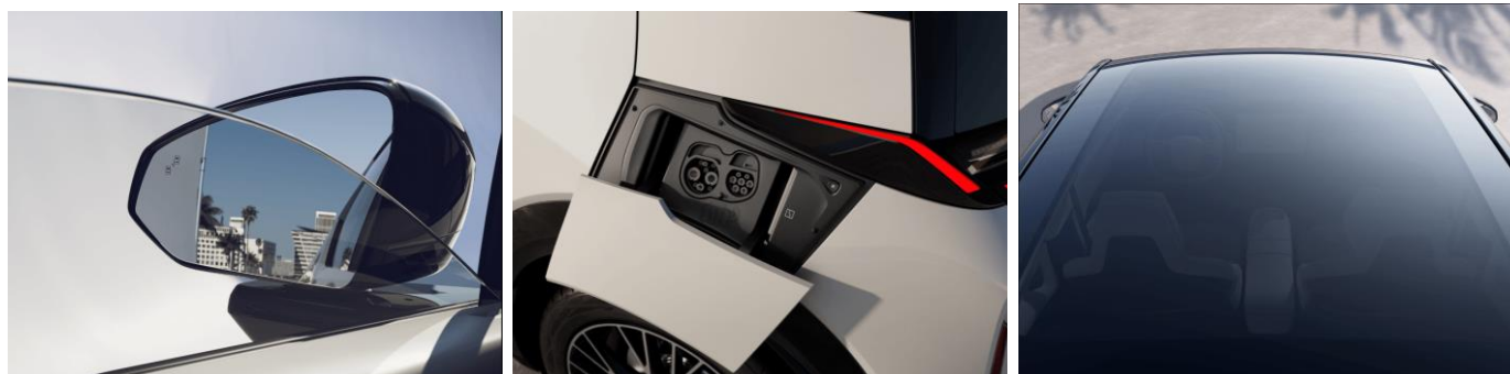
图 59：无边框电动外后视镜、隐藏式电动充电口盖、1.21 m²超大全景天幕示意图
