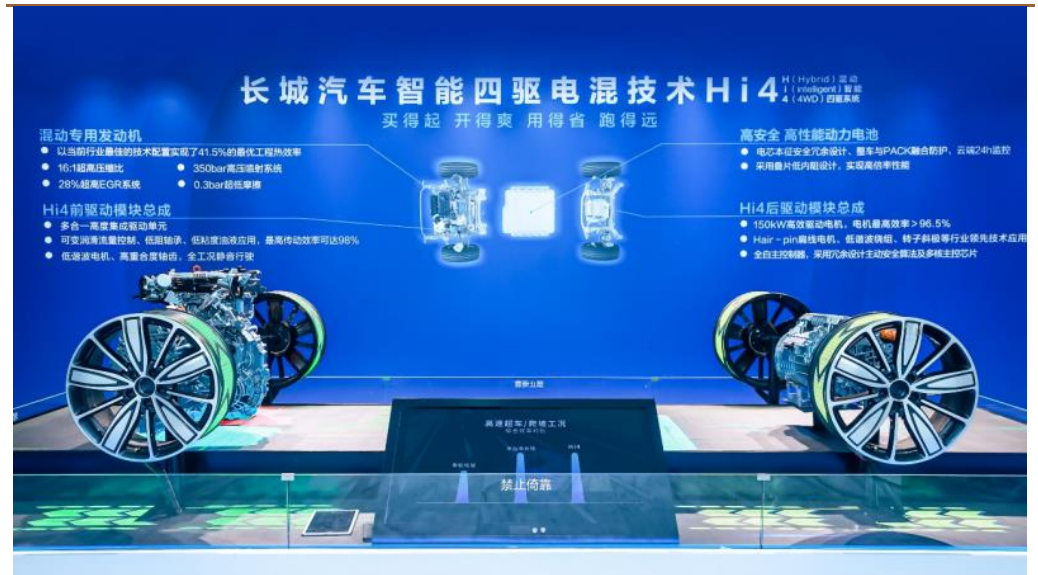
图 3：Hi4 技术通过前后轴双电机分布式布置，实现了串并联四驱的电混架构
