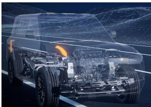
图 22：易四方技术平台具有四电机独立控制能力
