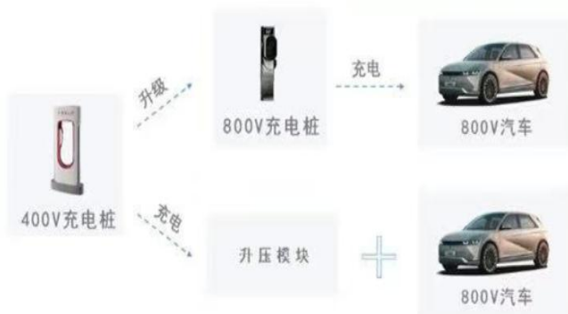
图 28：充电 800V+用电 800V 方案架构
