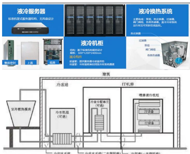
图34：喷淋式液冷系统工艺流程示意图
