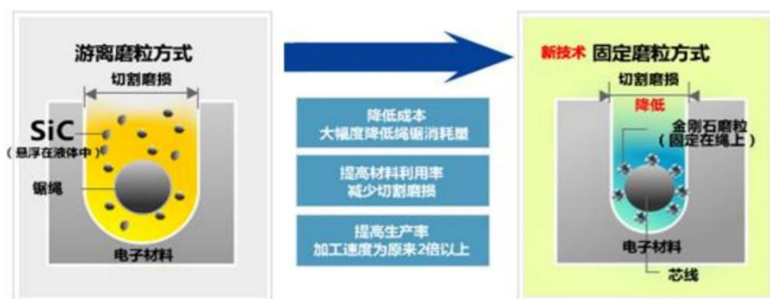
图 10：游离磨粒切割与金刚线切割工艺图
