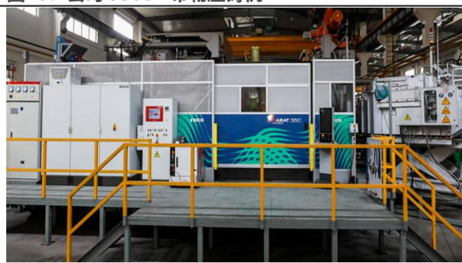
图26：公司3500T布勒压铸机
