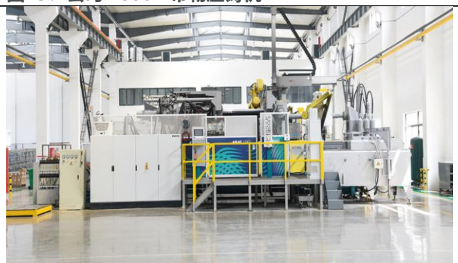
图25：公司1800T布勒压铸机
