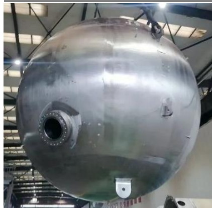
图18：核电机组内安注箱球体同样需要使用钛钢复合板
