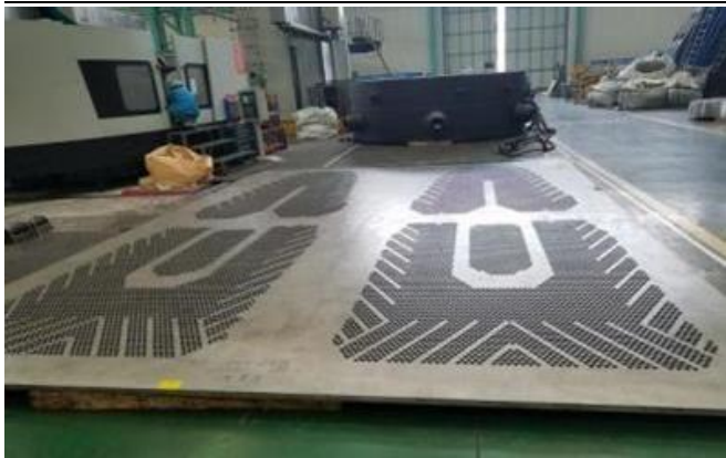
图17：钛钢复合板可用于冷凝器管板
