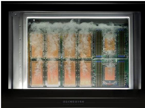
图 16：曙光浸没式相变液冷系统
