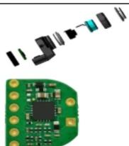
主要以发射和接收超声波雷达信号对障碍物进行测距并对驾驶员进行提示，从而对驾驶进行辅助。
