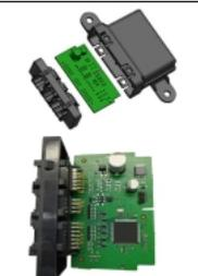
主要负责与车身进行通讯，接收车身信号进行工作逻辑处理以计算超声波探测的距离和区域并发出提示信号，对驾驶员低速驾驶提供警示。
