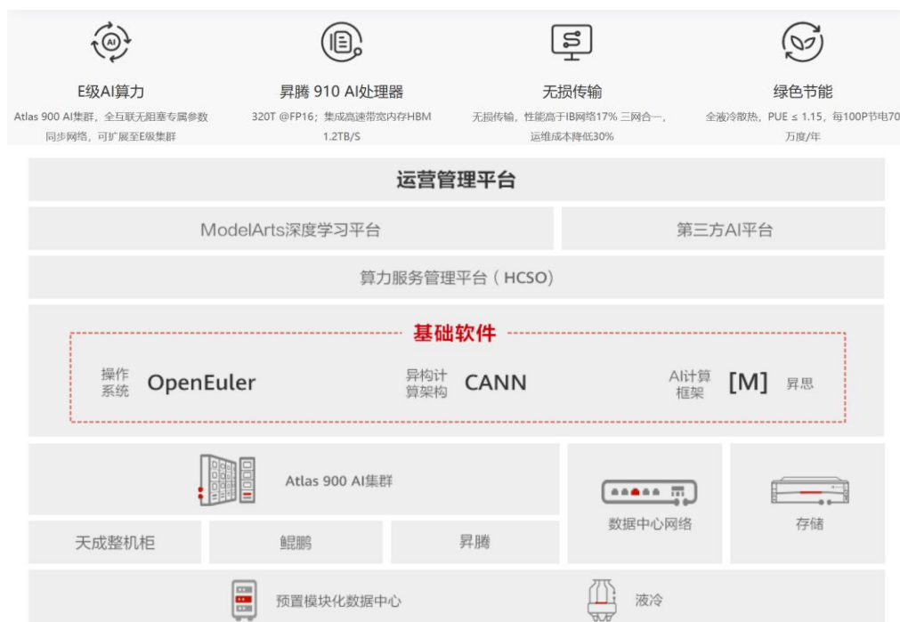
华为基于昇腾处理器的人工智能计算中心方案架构
