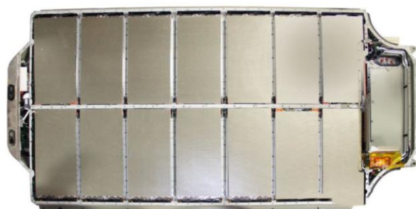
图30：某车型铝型材电池箱下体
