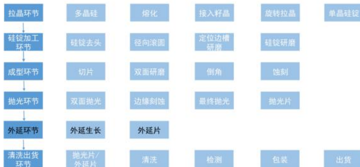
图：半导体抛光片、外延片工艺流程图
