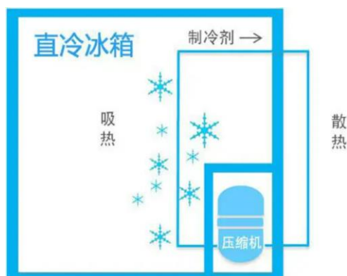
图10：直冷冰箱工作原理
