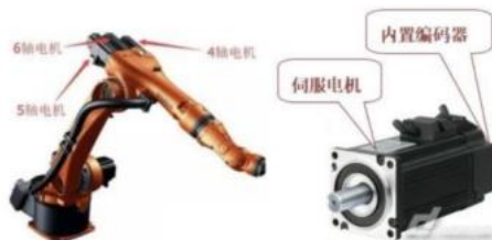
图21：编码器在机械手臂及伺服电机中的应用
