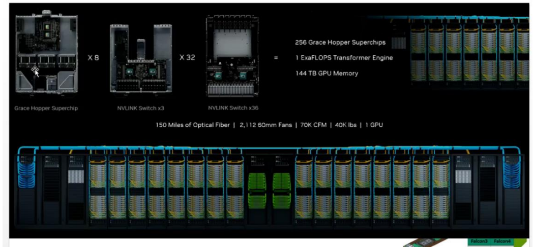
图表35: 英伟达 DGX GH200 超级 AI 计算集群可使用全光架构
