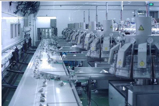
图表 44：五芳斋粽子生产线从粽叶清洗到真空灭菌等工序均已实现自动化
