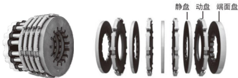
图表20：飞机碳碳复合材料刹车盘结构
