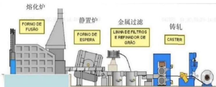
图15：传统电池铝箔需通过铸轧制作胚料
