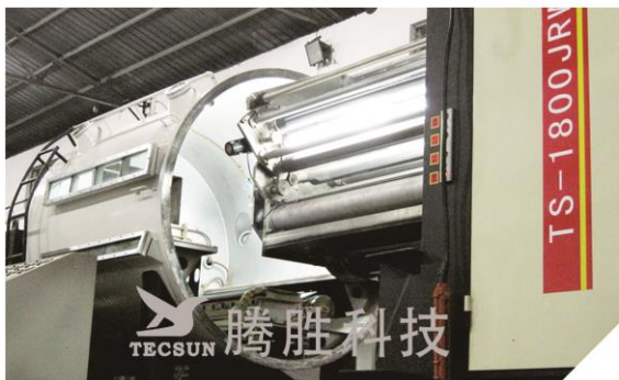
图13：腾胜科技蒸发式卷绕镀膜设备通过坩埚加热蒸发镀膜材料实现沉积工艺
