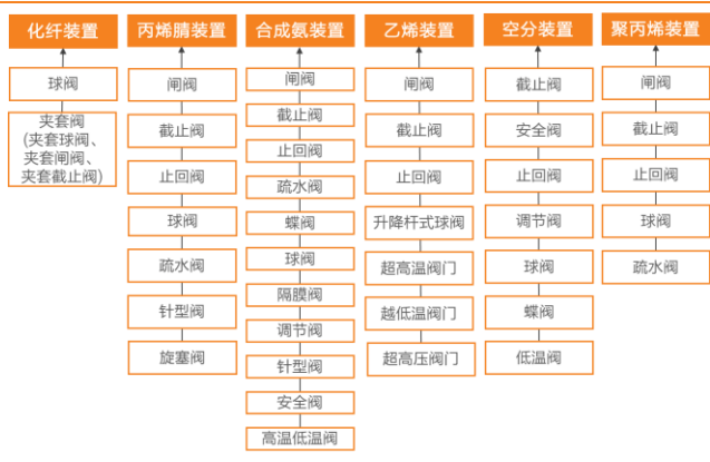
图 28：石化生产装置的阀门应用情况
