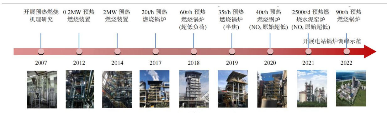
图13: 煤粉预热燃烧技术研发和应用历程
