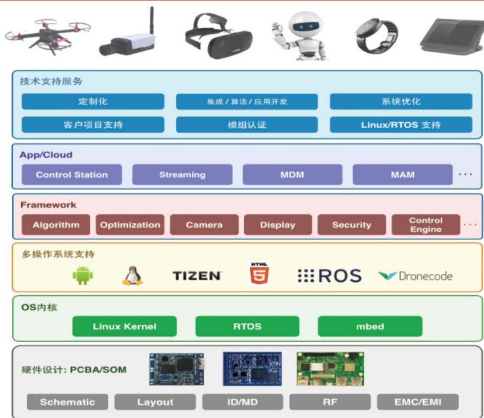
图49: TurboX 智能大脑平台技术架构
