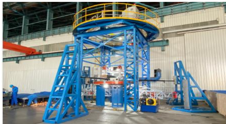
公司核装备成套设备——放射性污染混凝土烟囱内表面去污及内部工艺排气管拆除装置
