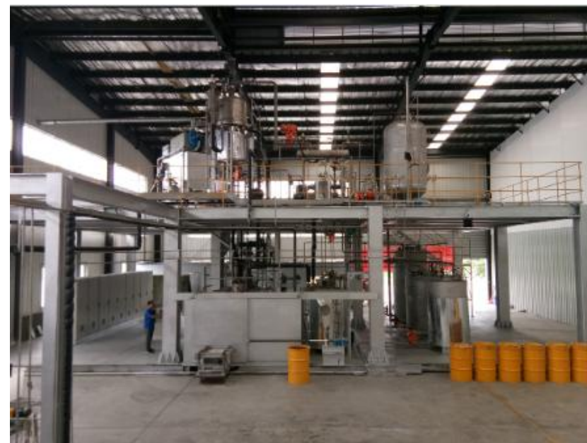
公司放射性含硼废液超浓缩固化生产线
