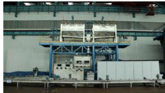
公司核装备成套设备——放射性焚烧灰收集、装桶及输运自动化生产线
