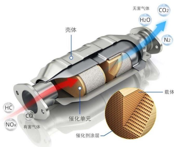
图34：尾气催化单元中的蜂窝陶瓷载体示意图
