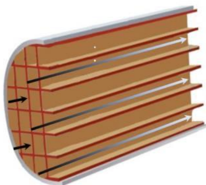
图35：直通式载体示意图
