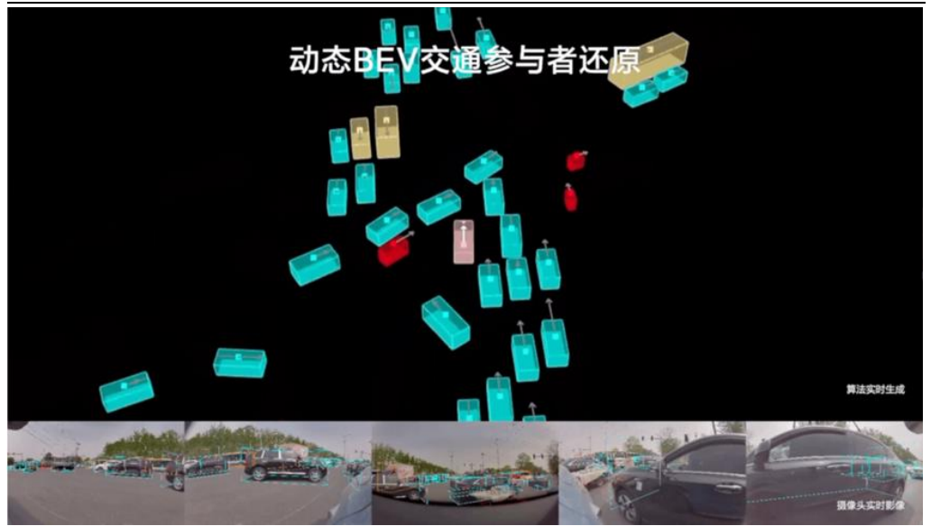
图19：动态 BEV 网络可实时还原车辆、行人等规则物体空间位置并预测其运动轨迹
