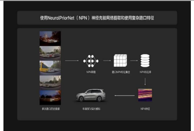
图15: 理想通过将 NPN 提取的先验信息与 BEV 实时感知相结合, 提升道路信息感知能力
