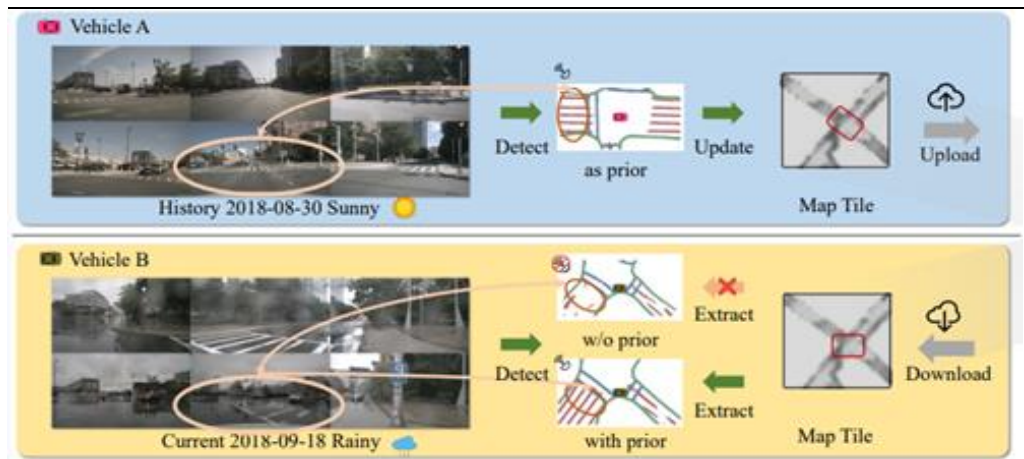
图16: 通过结合 NPN 网络的云端先验信息, BEV 网络生成的车道线信息更加精准
