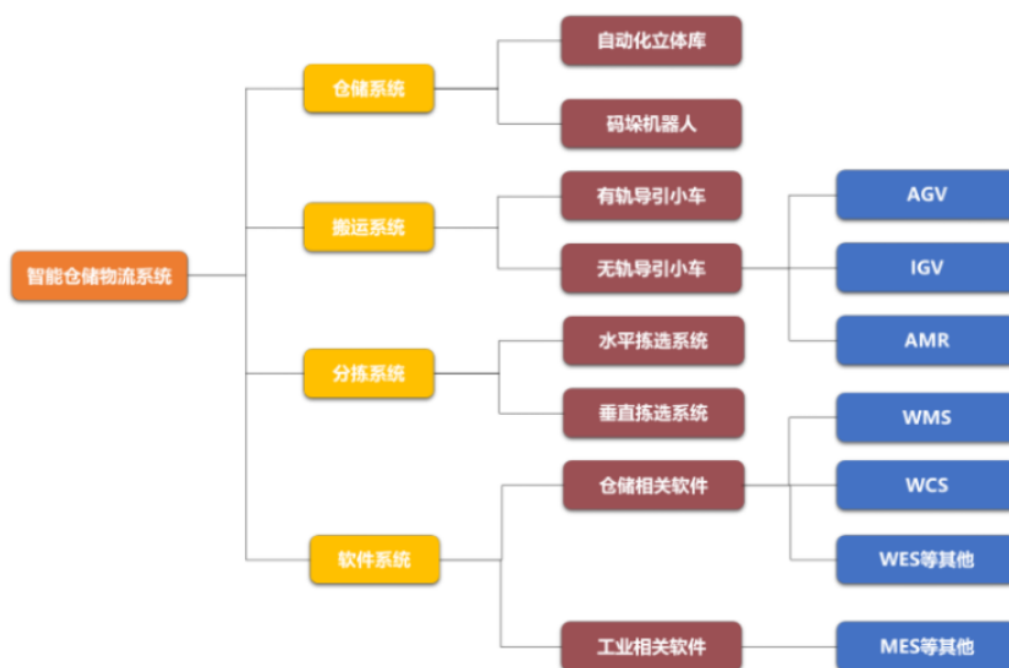
图表22：智能仓储物流系统由仓储系统、搬运系统、分拣系统、软件系统四部分组成
