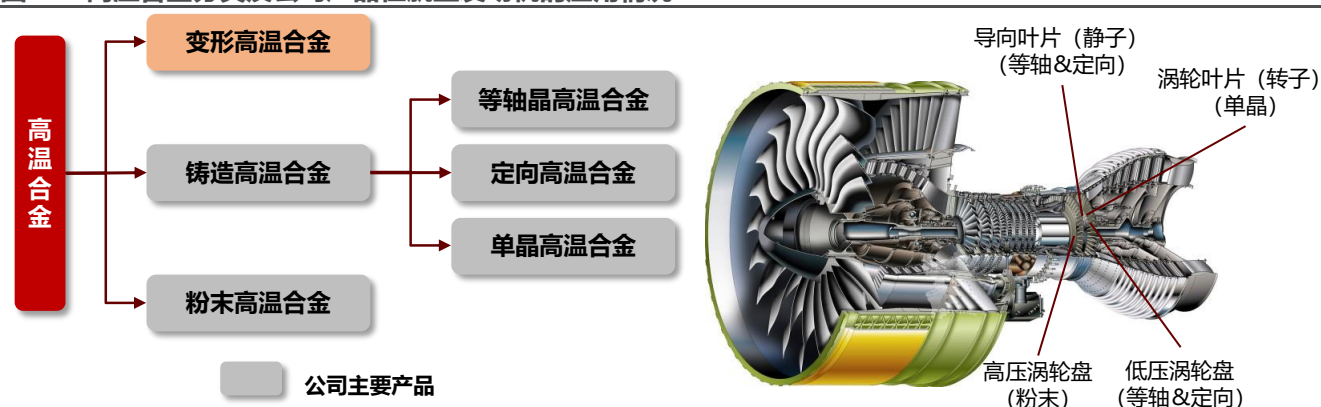
图26：高温合金分类及公司产品在航空发动机的应用情况
