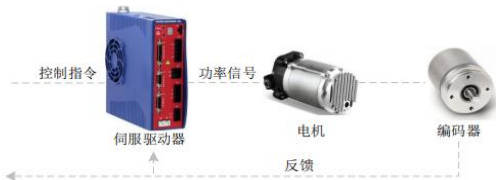
图 7：伺服系统基本结构
