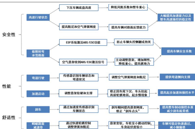
图55: 领克 ZERO 全自动空气悬架系统部分功能
