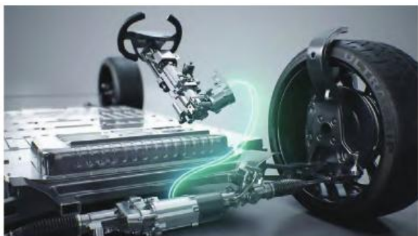
图53: 线控转向系统示意图
