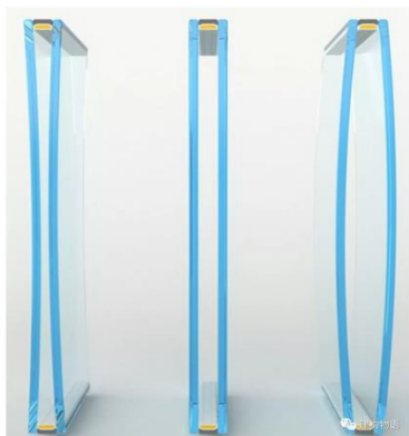
图表 75.大气压变化会导致常规玻璃面板变形
