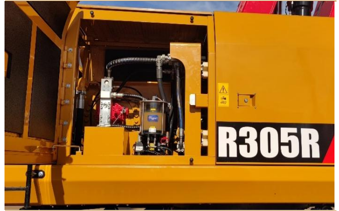
图 45：公司双线式集中润滑系统安装在三一旋挖钻 SR305R
