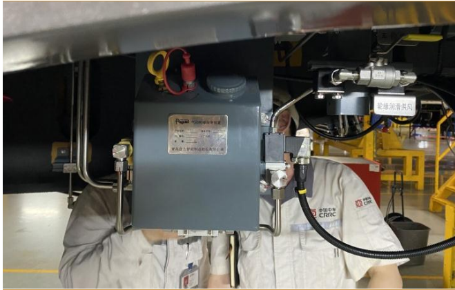
图 44：公司轨交轮缘润滑系统已经应用中车地铁车辆上
