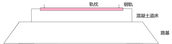
图表 12. 无砟轨道结构
