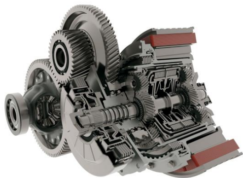
图35: IAV 研发的一种 P2 架构的专用混合动力变速器
