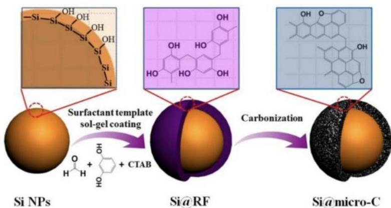
图12：Si/C 复合材料的合成机理图
