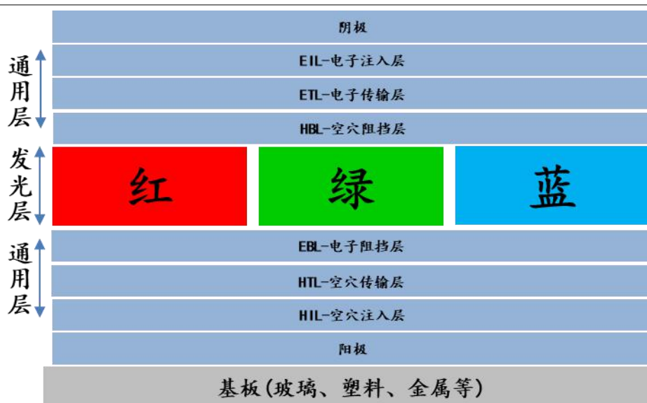
图18: OLED 面板结构
