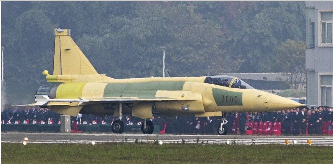
图 34：换装了南京 14 所研发的 KLJ-7A 型机载液冷电扫有源相控阵雷达的新一代“枭龙” Block3
