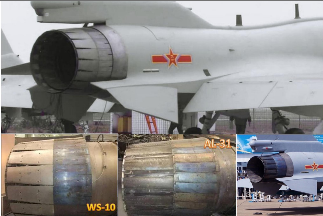
图 37：采用国产航空发动机 WS-10 替换俄罗斯 AL-31 的歼-10C
