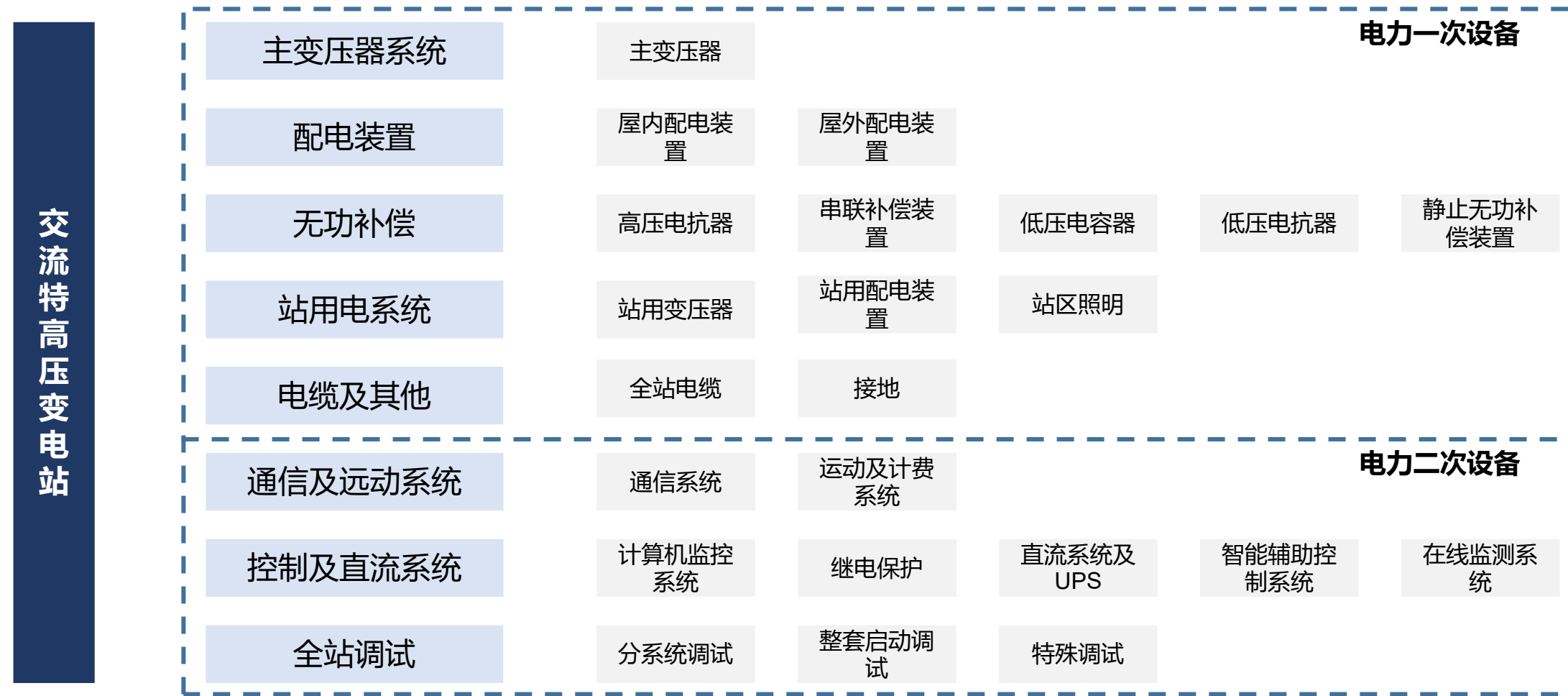
图35：交流特高压变电站主要设备构成
