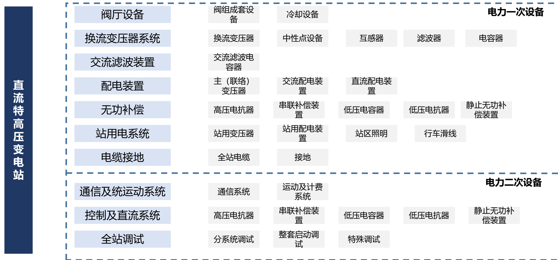
图36：直流特高压变电站主要设备构成
