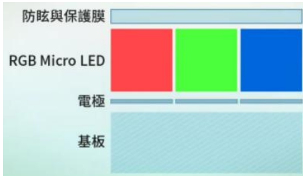
图 33: Micro LED 结构示意图
