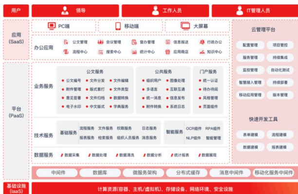
图表 32：WEP 数字化应用云平台技术架构
