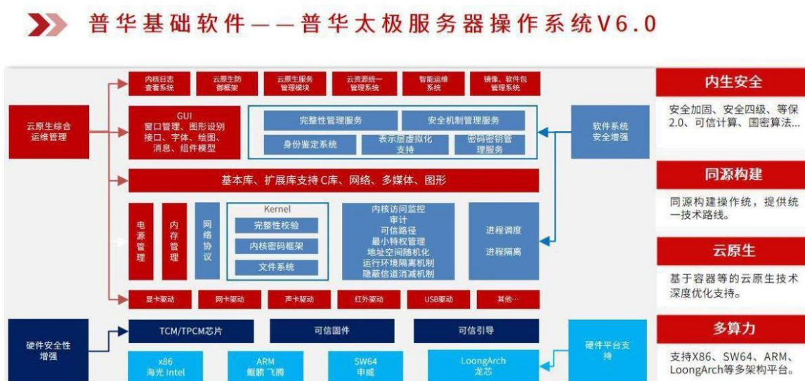
图表 17：普华太极服务器操作系统 V6.0 系统架构
