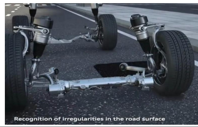
图 54：空气悬架示意图
