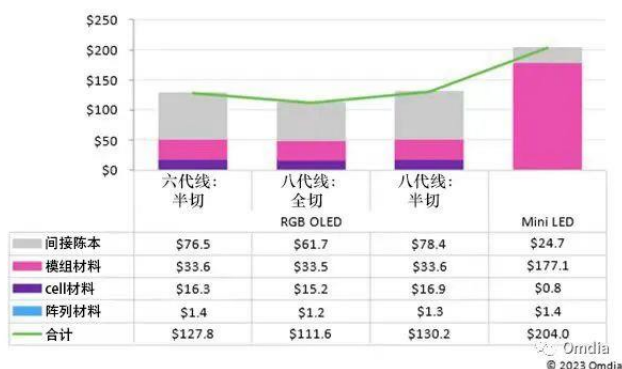
图表30：八代线 OLED 与六代线 OLED 和 Mini LED 背光液晶面板的对比
